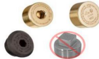
防爆設備未使用開孔需封閉， 並使用與箱體同規格之盲塞元件
